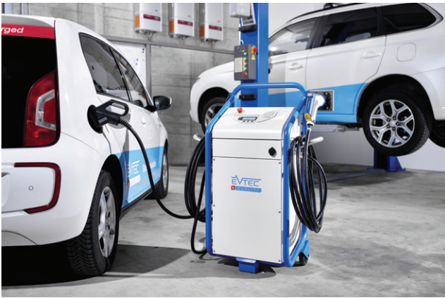
Fig. 30 : Exemple de borne de recharge mobile connectée au réseau par un connecteur CEE (source : EVTEC).
