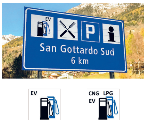
Fig. 59 : Panneau indiquant la présence de bornes de recharge dans une zone de service et pictogrammes internationaux pour indiquer la présence de bornes de recharge.
