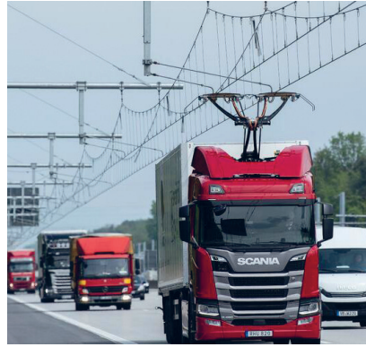
Fig. 16 : Une solution pour la recharge occasionnelle des camions consiste à doter des bouts de route d'une ligne aérienne à laquelle ils peuvent être reliés par un pantographe (source : handelsblatt.com, eLKW Pantograph eHighway).
