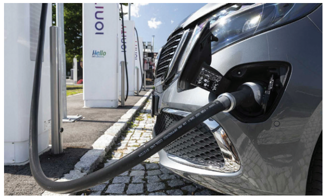
Fig. 10 : Sur le Mercedes-Benz Van (EQV), le connecteur est placé du côté latéral à droite du pare-chocs avant (position 8). (Quelle: motor1.com)
