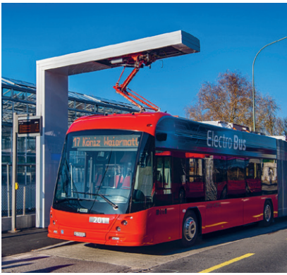
Abb. 15: Das Gelegenheitsladen findet typischerweise an den Haltestellen statt und zeichnet sich durch eine hohe Leistung und Pantographenverbindung aus (Quelle: luzernerzeitung.ch, E-Bus Zug).
