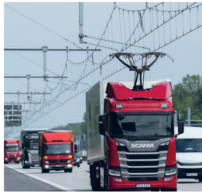
Abb. 16: Eine Lösung für das LKW- Gelegenheitsladen besteht darin, Strassenabschnitte mit einer Luftlinie zu versehen, an der LKWs mit einem Stromabnehmer angeschlossen werden können (Quelle: handelsblatt.com, E-LKW Pantograph E-Highway).
