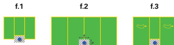
**Fig. 43:** Possibili punti d'installazione della stazione di ricarica per motocicli e quadricicli presso parcheggi pubblici e autosili. Nel caso **f.1** la stazione serve tre stalli per motocicli, nel caso **f.2** serve tre stalli per quadricicli mentre nel caso **f.3** due stalli per quadricicli sono combinati con uno stallo per motocicli.
