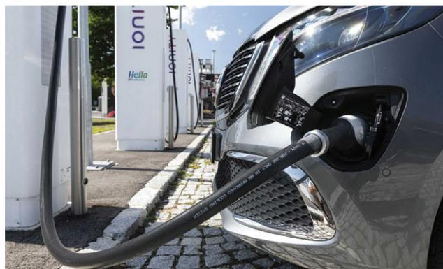
**Fig. 10:** Sul Mercedes-Benz Van (EQV) il connettore è posizionato sulla parte anteriore, lato conducente (Pos. 8). (fonte: motor1.com)
