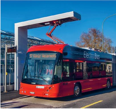
**Fig. 15:** La carica occasionale avviene tipicamente durante le soste ed è caratterizzata da un'elevata potenza e da una connessione tramite pantografo (fonte: luzernerzeitung.ch, eBus Zug).
