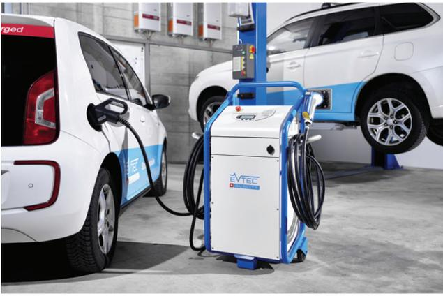
**Fig. 30:** Stazione di ricarica mobile collegata alla rete con una spina CEE (fonte: EVTEC).
