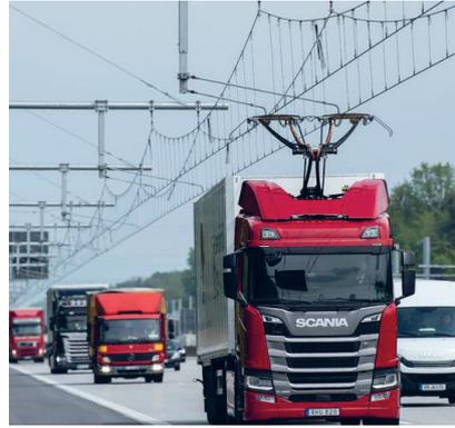
**Fig. 16:** Una soluzione per la carica occasionale degli autocarri è di dotare dei tratti di strada di una linea aerea a cui connettersi tramite pantografo (fonte: handelsblatt.com, eLKW Pantograph eHighway).
