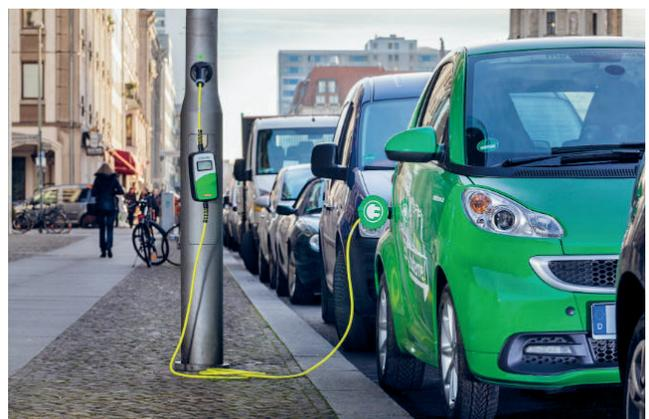
**Fig. 79:** Sistema con contatore integrato nel cavo (Ubitricity).
